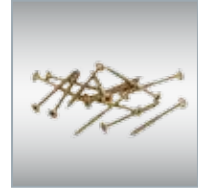
AQUAPANEL Maxi screw TB Τρυπανόβιδα με 500 ώρες τεστ-αντοχής σε αλατόνερο, για πάχος λαμαρίνας από 0.7mm έως 2,25mm.
