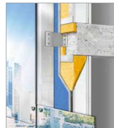
Αεριζόμενη πρόσοψη με υαλοπίνακες
